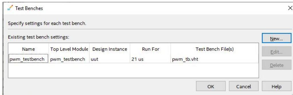
A continuación, seleccionar “pwm\_testbench” y clicar en *Edit* para editar la configuración del banco de pruebas para comprobar la configuración. Debería obtenerse lo siguiente.
